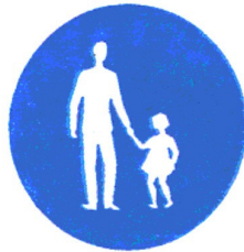
(P - 55) Οδός υποχρεωτικής διέλευσης πεζών, (απαγορευμένης της διέλευσης άλλων εκτός πεζών, οχημάτων άμεσης ανάγκης και οχημάτων για την είσοδο - έξο- δο σε παρόδιες ιδιοκτησίες).
