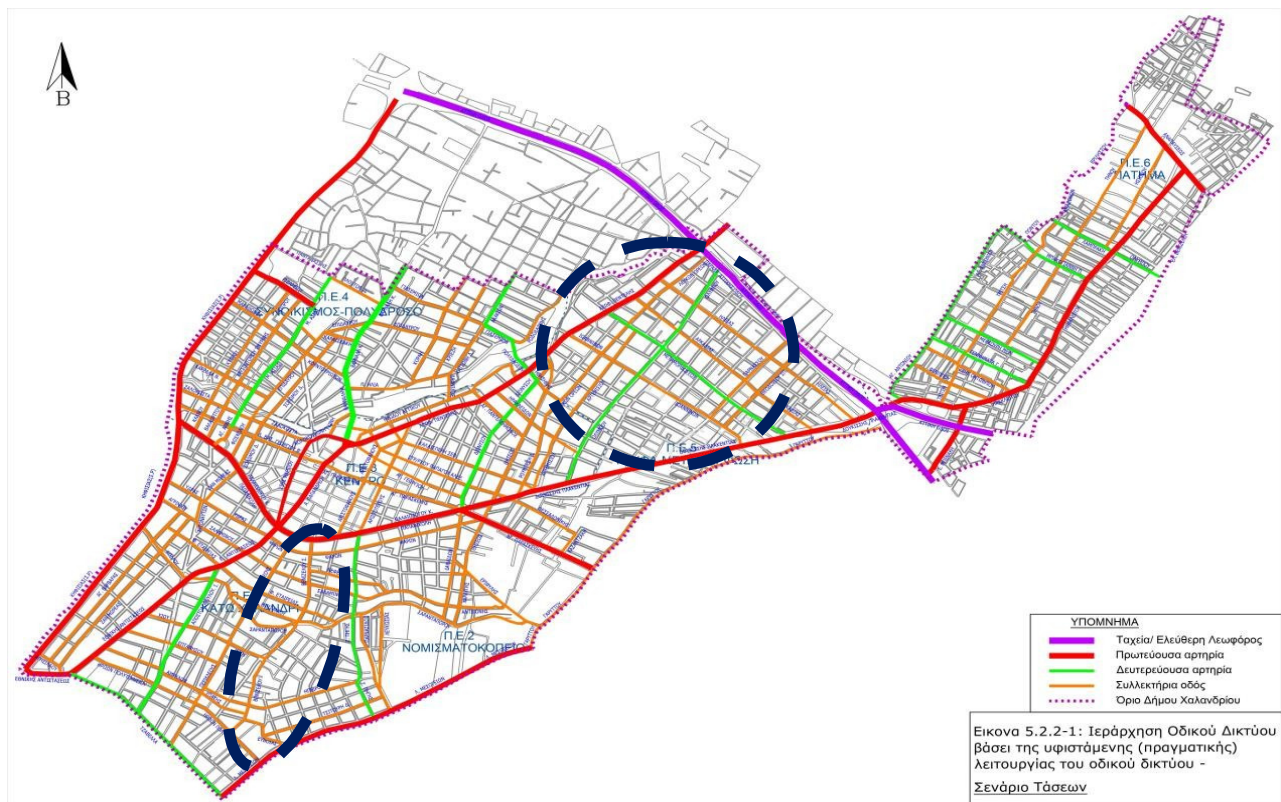
Εικόνα 1 Η θέση των οδών Σοφοκλή Βενιζέλου και Ολύμπου-Μεταμορφώσεως στην περιοχή του Χαλανδρίου και εκτίμηση της βαρύτητάς τους στο οδικό δίκτυο βάσει της πραγματικής λειτουργίας (ΣΒΑΚ 2019, σελ 67)
