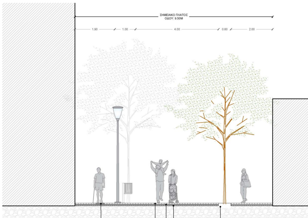
Εικ. 18: Διατομή της προτεινόμενης διαμόρφωσης της οδού Χαϊμαντά
