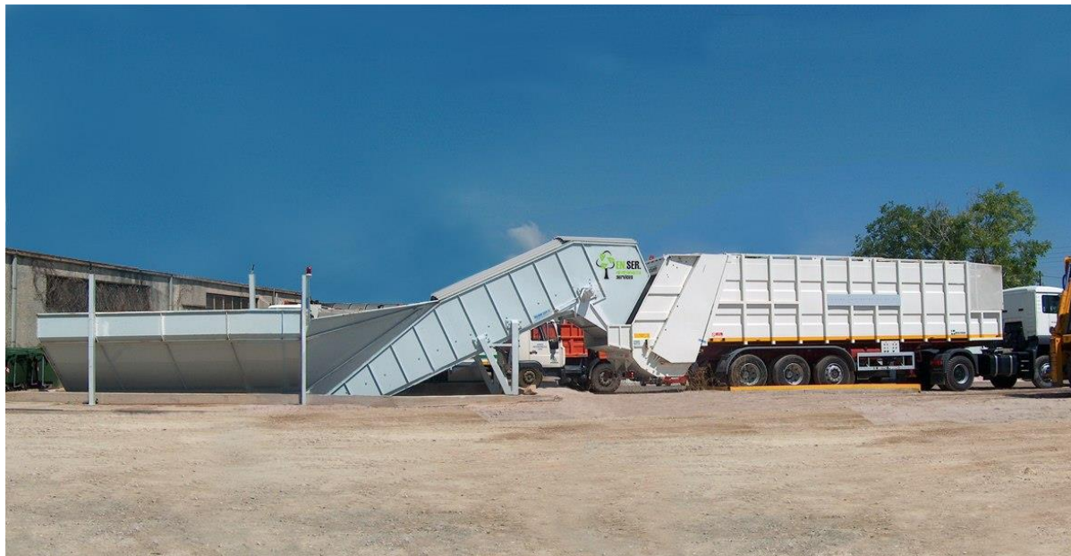
Εικ. 8.1. ΣΜΑ χωρίς πάγιες εγκαταστάσεις αποτελούμενος από μεταφορική ταινία και ημιρυμουλκούμενο όχημα 40-50m 3 .
