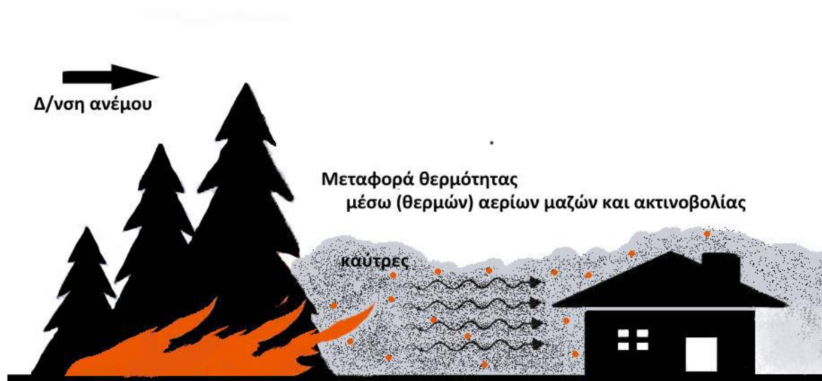
Σχέδιο 4. Τρόποι ροής της θερμότητας σε μια δασική πυρκαγιά, που εξελίσσεται πλησίον κτιρίου και απεικόνιση πιθανού τρόπου μετάδοσης δασικής πυρκαγιάς με μεταφερόμενες καύτρες σε κτίρια παρουσία ισχυρού ανέμου
