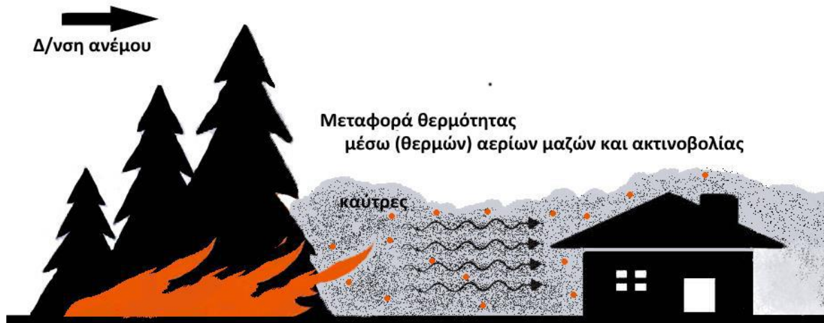
Σχέδιο 4 Τρόποι ροής της θερμότητας σε μια δασική πυρκαγιά, που εξελίσσεται πλησίον κτιρίου και απεικόνιση πιθανού τρόπου μετάδοσης δασικής πυρκαγιάς με μεταφερόμενες καύτρες σε κτίρια παρουσία ισχυρού ανέμου
